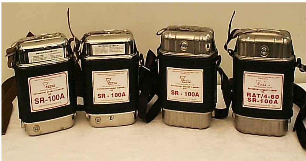
Rys. 13.1. Aparat regeneracyjny ucieczkowy typu SR-100A (RAT/4-60SR-100A) z tlenem chemicznie związanym (układ oddechowy zamknięty)
